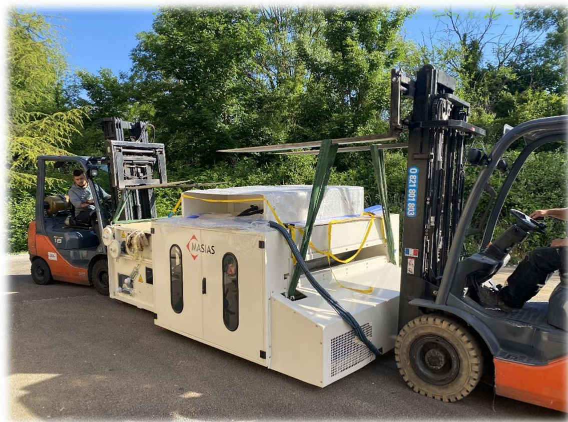
Figure 27 : méthode utilisée pour transporter la machine à l'atelier
